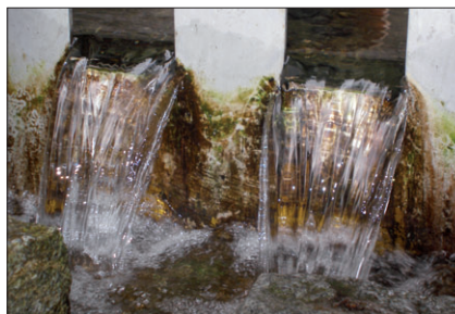
Měření vydatnosti pramene na obdélníkovém přepadu
