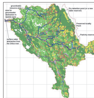
Schéma říční sítě povodí Orlice sestavené v modelu HEC-ResSim, vyznačeny jsou významné vodohospodářské lokality v povodí
