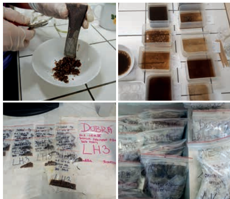
Obr. 9. Zpracování písku a jemného organického materiálu (FPOM) z vyjmutých válečků a válců v laboratoři (první foto: J. Horáčková)
