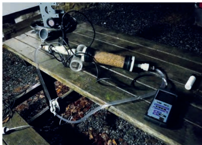
Obr. 8. Měření respirace ve válcích v podmínkách in situ Fig. 8. Measurement of respiration in cylinders under in situ conditions
