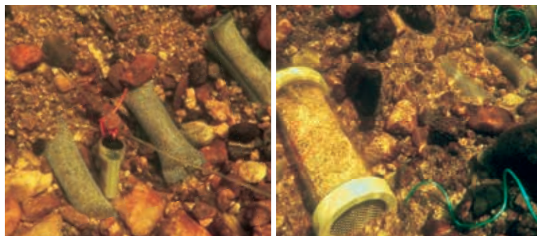
Obr. 5. Příklad umísťování válečků, teploměrů a jednoho válce do hloubky 3–5 cm hyporheálu na lokalitách Ovesná a Studená Vltava (zleva)
