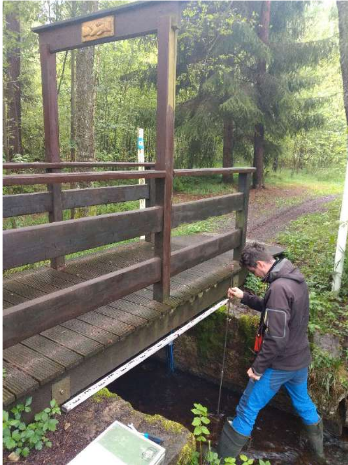
Obrázek 23. Hydrometrování na Újezdském potoce
