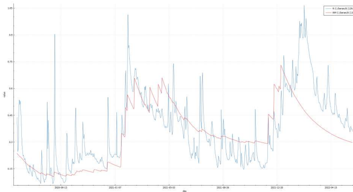
Obrázek 26. Pozorovaný (modře) a modelovaný (červeně) odtok z povodí Újezdského potoka (11. 6. 2020 – 31. 5. 2022)
