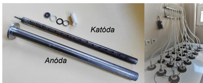
Obrázok 3 • Zloženie elektrolytickej bunky a ich zapojenie do systému.
